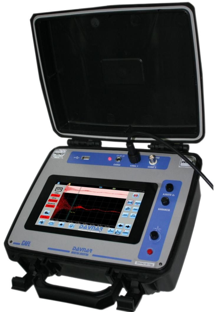
**Accesorios incluidos:** \* Cable (1,3 m) coaxial 50  $\Omega$  conector BNC aislado a cocodrilos aislados reemplazables. \* Cargador/alimentador: 100-240 V - 19 VCC. **Accesorios opcionales:** \* Acoplador para modo GOC. \* Acoplador para modo RDT. \* Acoplador para modo RDA. \* Software para análisis de reflectogramas en PC. (CafViewer).
